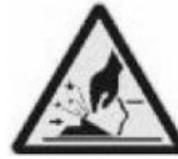
Remarque : lorsque vous appuyez sur le pneu, si le cylindre de serrage est ouvert, ça va égratigner la main du opérateur. Gardez à l'esprit que la main ne doit pas entrer en contact le flanc du pneu.
