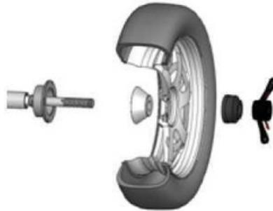
arbre principal → printemps → cône approprié → roue → entretoise → écrou à serrage rapide
