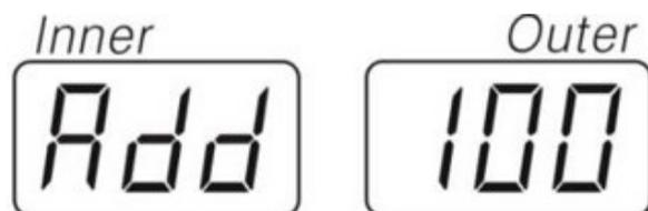
Une fois la rotation terminée, l'écran affichera « 100—ADD », à ce stade, vous devez d'abord retirer le poids d'étalonnage de 100 g du bord extérieur de la jante, puis placer ce poids d'étalonnage de 100 g à la position 12 heures sur le côté intérieur.
