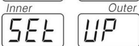
1 "SET" – "UP" Presse
