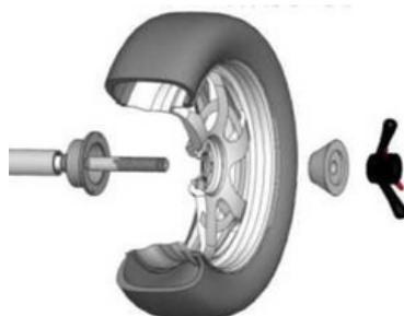
arbre principal → roue (surface de montage de la jante vue de l'intérieur) → cône → écrou à serrage rapide
